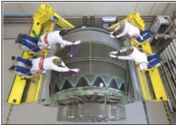
Abbildung 1: Manuelle Fertigung von Faserverbundkomponenten für den Triebwerksbau (Quelle: FACC)
