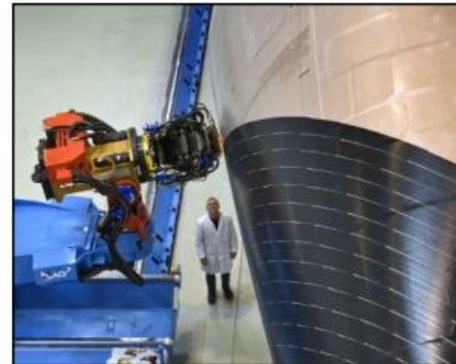
Abbildung 2: Rumpfsegment – Herstellung mit Automated Fiber Placement Verfahren (Quelle: PAG)
